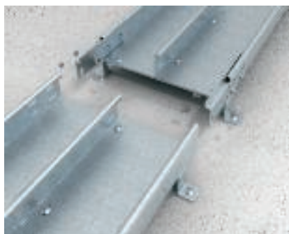
Vaheseinapaigaldus Vaheseina paigaldamine trassi sisse kaablite ja juhtmete või vooluahelate eraldamiseks ning kaane täiendavaks stabiliseerimiseks alates laiuselt 400 mm.
