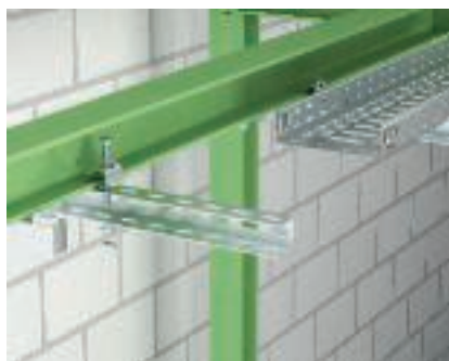
Konsoolkandur terasel U-profiili kui konsoolkanduri paigaldamine teraskandurile. Kinnitamine sõltuvalt koormusest klambernurkade või pingutussõrgadega. Vahedetaili kinnitamine vahedetailidega DSK.
