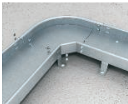
Põlve montaaž Põlved laiuselt 100 kuni 300 mm lukatakse ühelt küljelt talasse ja teiselt küljelt üle ühenduse, laiuste 400 kuni 600 mm korral on vaja standardühendust.
