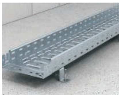
Vahega pörandakinnitus Kaablirenni distantspaigaldamine distantsklambriga DBL. Maksimaalne kaablirennilaisus 400 mm.
