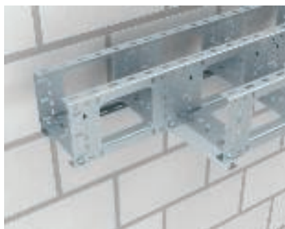
BKK-kinnitusvariant (viltu) Nihkes asetsevate ühenduskohtadega BKK-profiilide võimalik paigaldusvariant. See paigaldusvariant parandab ühenduskohtade stabiilsust.
