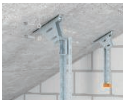
Muudetav peaplaat Muudetava peaplaadi KU 5 V kinnitamine kaldus betoonlaele poltankru (tüüp FAZ II) ja vahedetaili DSK 47 abil.
