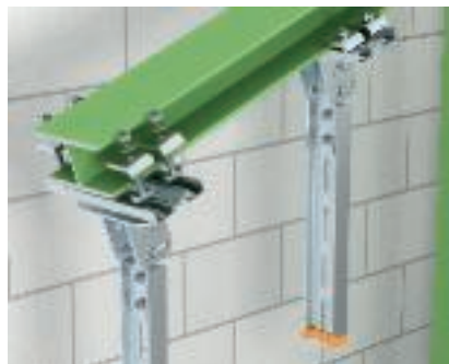
Kasutamine kaldus teraskanduril Klamberkinnitused klambernurkade ja pingutussõrgade abil kaldus teraskanduritele.
