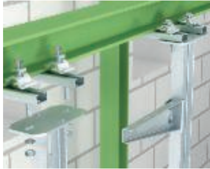
C-profiiliga terasklamber, põikisuunaline trass I-ripusprofiili monteerimine, kinnitatud teraskandurile C-profiili ja pingutussõra TKH-L-25 abil. Trassi kulgemine põiki teraskandurit.
