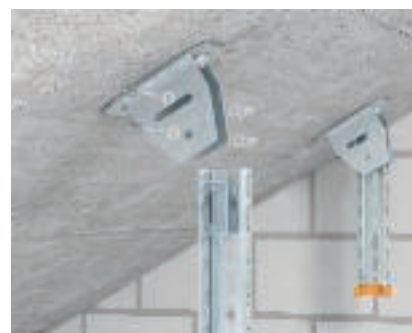
Muudetav peaplaat Muudetava peaplaadi KU 7 VQP kinnitamine kaldus betoonlaele poltankru (tüüp FAZ II) ja vahedetaili DSK 45 abil.
