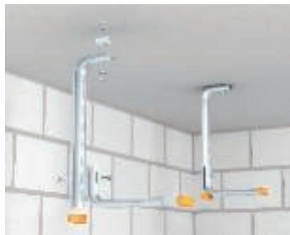
Paigaldus: TP-riputusprofiil koos ühepoolse kandurikinnitusega TP riputusprofiili lakke monteerimine vahedetaili DS 4 ja ühepoolse kanduri abil. Trassi maksimaalne laius 300 mm.
